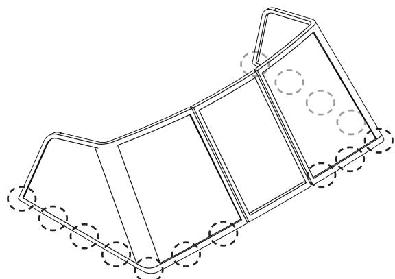
Устанавливаем рамку на место и фиксируем ее на лодке винтами через подготовленные ранее отверстия.
