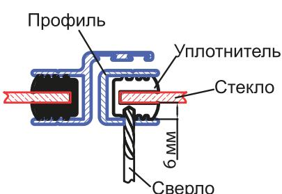
Сверловка бокового профиля для крепления упорных стоек.
