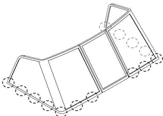
В нижнем профиле рамки есть отверстия, через которые будет осуществляться крепление ветрового стекла к корпусу лодки. В случае если по какой-то причине вы не можете использовать данные отверстия, необходимо самостоятельно просверлить профиль рамки в ближайшем доступном месте используя для этого сверло диаметром 4,8-5 мм.
