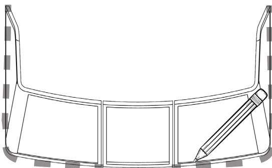
Очерчиваем контур рамки карандашом для наклеивания уплотнителя (под рамку) с клеевой основой.
