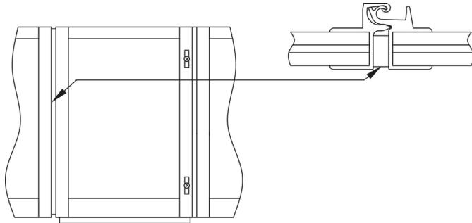
Наклеиваем уплотнитель 6х12 в проём калитки.
